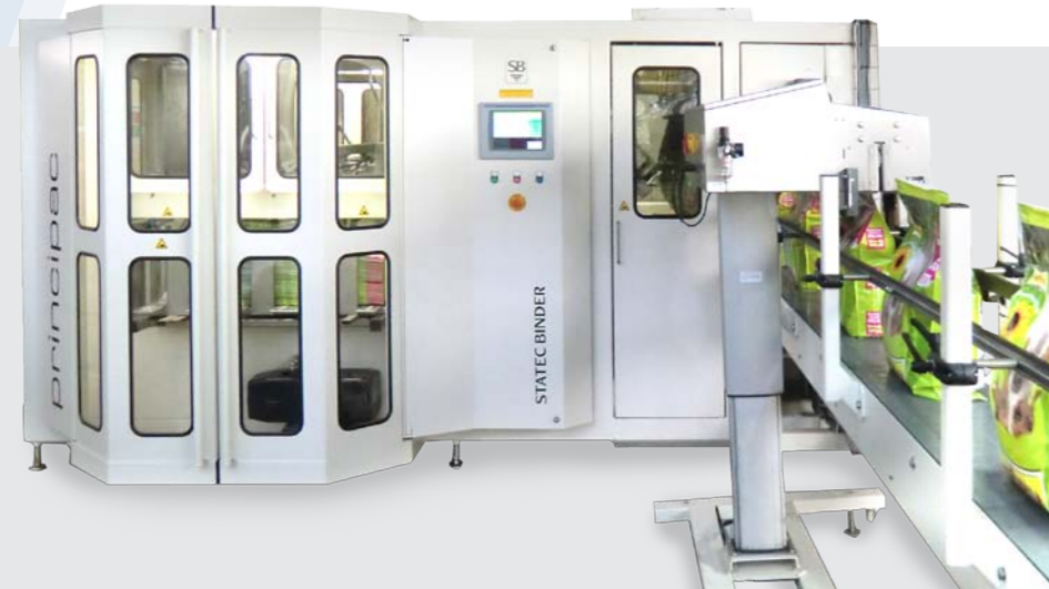
Zwei Maschinen vereint zu einem kompakten Verpackungssystem Two machines united to one compact bagging system
