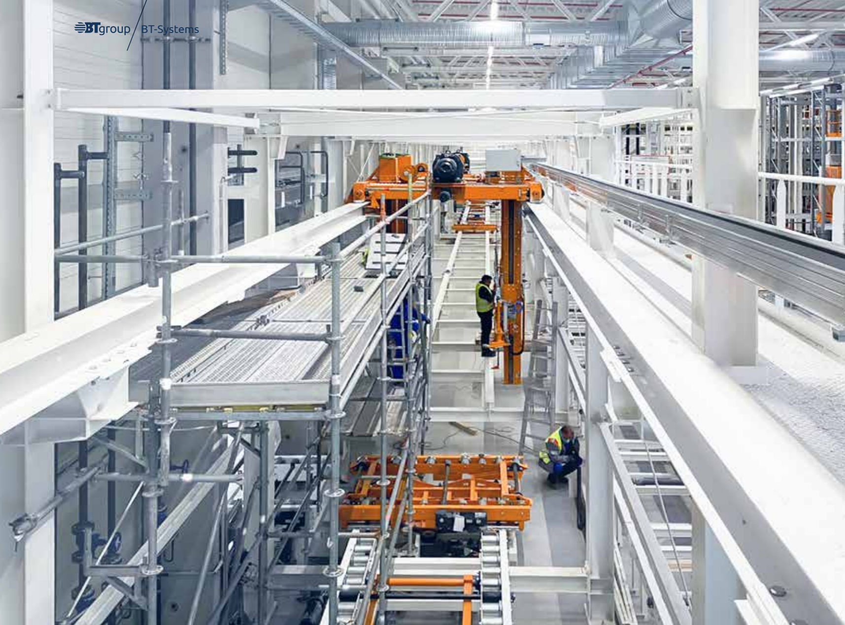
Stapelportal für Batterieładungsträger (3.500 kg Nutzlast) | Stacking gantry for battery load carriers (3,500 kg payload)
