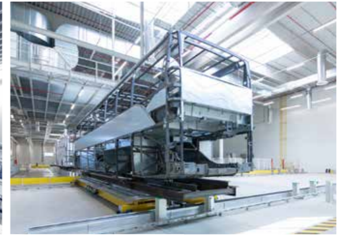
Verschiebewagen mit Skid-Rollenbahn für Busfertigung Transfer car with skid roller conveyor for bus production
